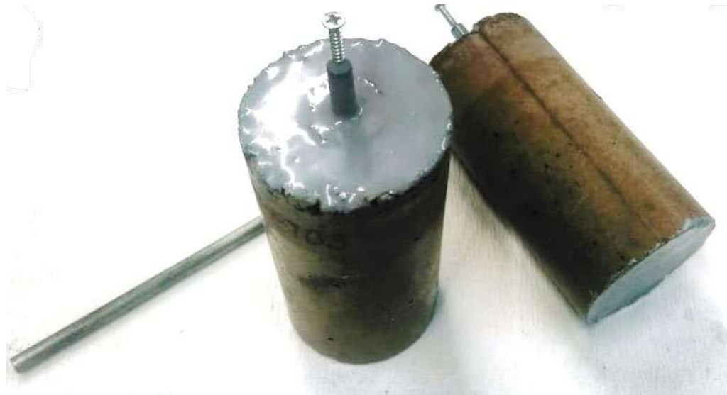
Figura 1. Probeta de mortero utilizada para medir las propiedades electroquímicas. Fuente: Autores.
